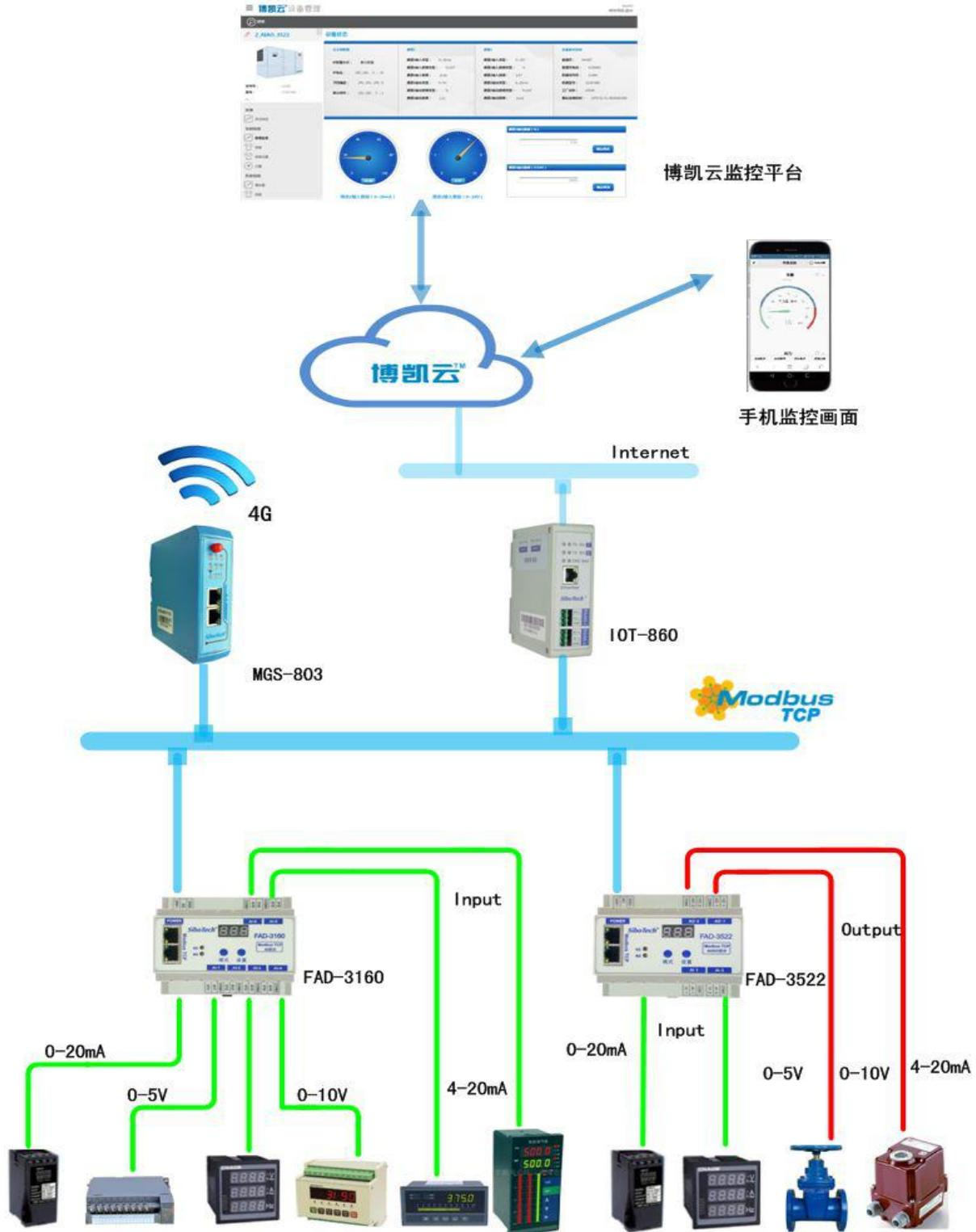
FAD-3160+IOT-860/MGS-803 可以把 6 通道的输入模拟量通过 Internet/4G 上传到博凯云，在博凯云和手机移动端实现远程监控。
